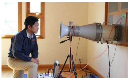
全棟高性能保証表示システム (プラン確定時に断熱性能を示すQ値・U値を計算、お引渡し時に全棟で気密性能を表すC値を実測し、住まいの性能を確認します。)
