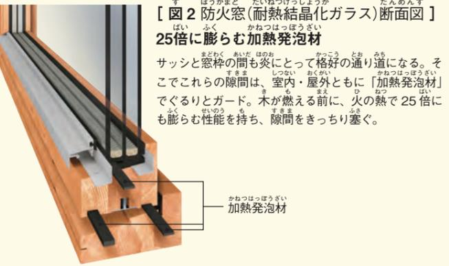
【図2 防火窓(耐熱結晶化ガラス)断面図】25倍に膨らむ加熱発泡材
