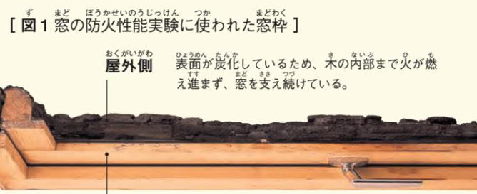
【図1 窓の防火性能実験に使われた窓枠】
