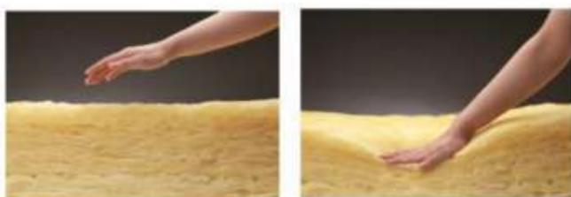
**スウェーデンハウスに最も適した断熱材「グラスウール」**
