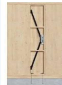
小規模な揺れに対し、さらなる「堅牢さ」を発揮。巨大地震の揺れに対しては、高性能な摩擦ダンパーにより建物への衝撃を大幅に軽減します。メンテナンスの必要もなく、何度でも効果を発揮。守護神のような存在として、大切な住まいをいつまでも見守り続けます。
