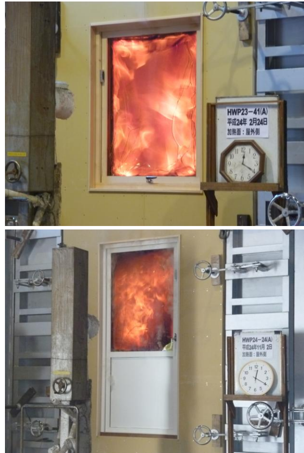
(上) 加熱 20 分終了時の防火窓 (下) 加熱 20 分終了時の防火片開きドア 最高温度が約 800℃に達するものの、いずれの試験体も非加熱側に炎の侵入はなく合格
