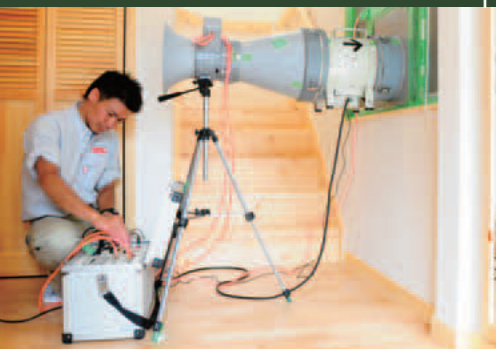
1 全棟気密測定導入前の研修風景。
